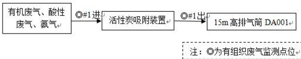
图 3-1 项目废气处理流程示意图
