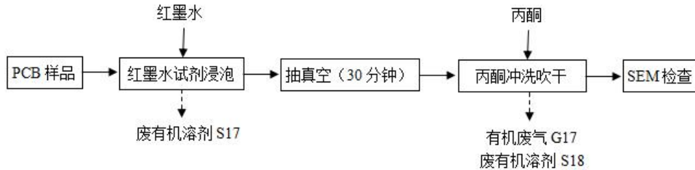
图 2-23 PCB 样品染色工艺流程及产污环节图
